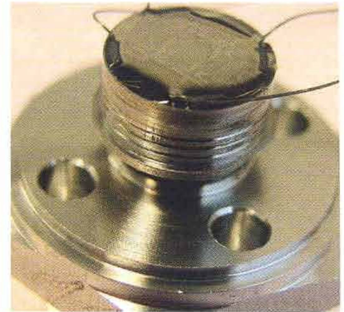
4 Edelstahl-Messzelle, verschweißt, elektrisch kontaktiert mittels Leitkleben (Sensor-Technik Wiedemann)
