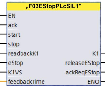
Er verfügt über die links stehenden Ein- sowie die rechts stehenden Ausgänge. Die Eingänge „ack“, „start“, „stop“ und „estop“ stehen über die S7-Eingangsbaugruppe direkt mit den Bedienelementen S1 bis S4 in Verbindung.
