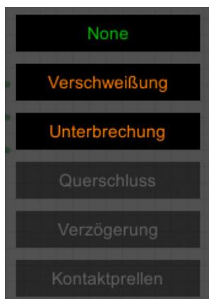
Um im SafetySim einen solchen Fehler zu simulieren, muss man mit dem Mauszeiger auf die Schützkontakte gehen und einen kurzen Klick mit der rechten Maustaste durchführen. Jetzt erscheint rechts oben auf dem Bildschirm ein Auswahlmenü.
