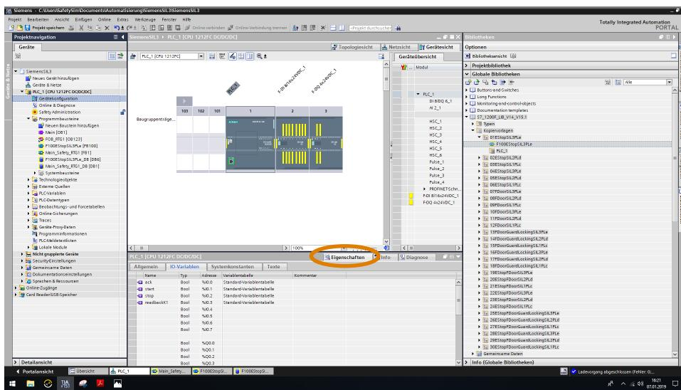
Das mittlere obere Fenster zeigt eine Abbildung des vorhandenen Steuerungssystems, in dem die CPU markiert ist. Nun muss im unteren mittleren Fenster der Reiter „Eigenschaften“ gewählt werden und in der nächst tieferen Ebene „IO-Variablen“. Dort ist bei Adresse „%IO.4“ „readbackK2“ einzutragen.
